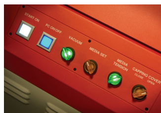
Un système d'aspiration automatique offre une aspiration régulière tout au long du processus d'impression.
