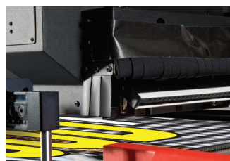
Les capteurs de sécurité de la navette empêchent les têtes d'impression de toucher le support. La barre d'ionisation empêche les charges électrostatiques. Ces éléments sont situés sur la navette.
